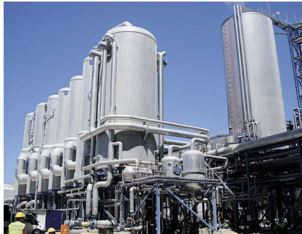
Nowy system wyparny został zaizolowany wełną mineralną i osłonięty blachą ze stali szlachetnej.
