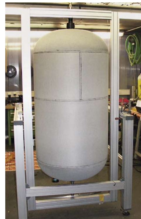
Zbiorniki z wykładziną zamocowane w przyrządzie badawczym do przeprowadzenia pomiaru i testu helowego.
