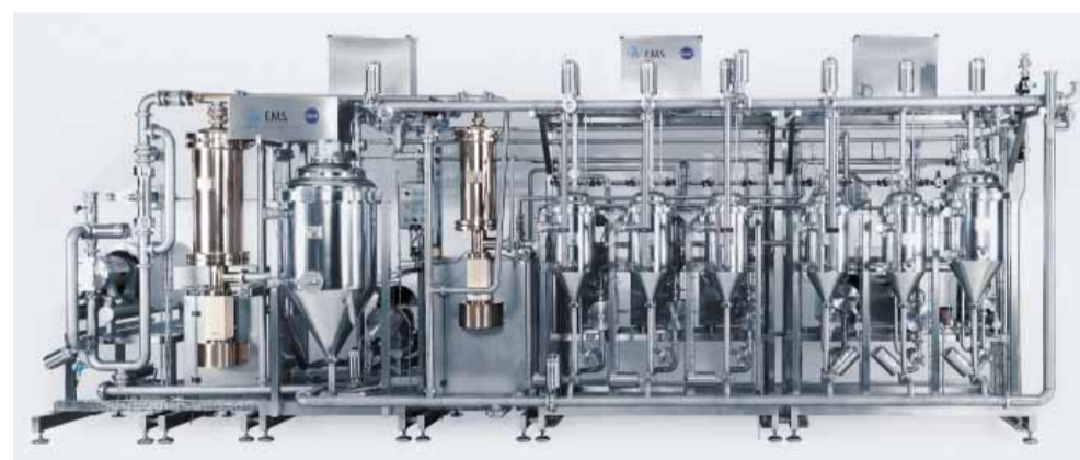
Die Produktionsanlage von BIS E.M.S., die bei Fingers Feinkost stündlich 2.000 bis 3.000 kg Mayonnaise produziert, besteht aus sieben Dosiersystemen und zwei Schlaufenmischern.
