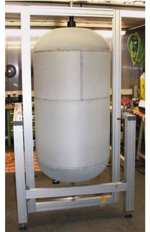
Liner-Behälter eingespannt in der Prüfvorrichtung zum Messen und zur Heliumprüfung.
